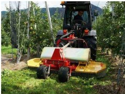
a) rozdrabnianie gałęzi za pomocą maszyny Seppi – Apple Vario [7]
